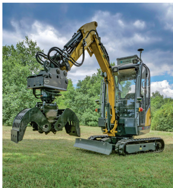
Die Alubox auf dem Dach ersetzt den Menschen in der Kabine: der autonome Bagger IOSB.BoB auf dem Weg zum Einsatzort.
