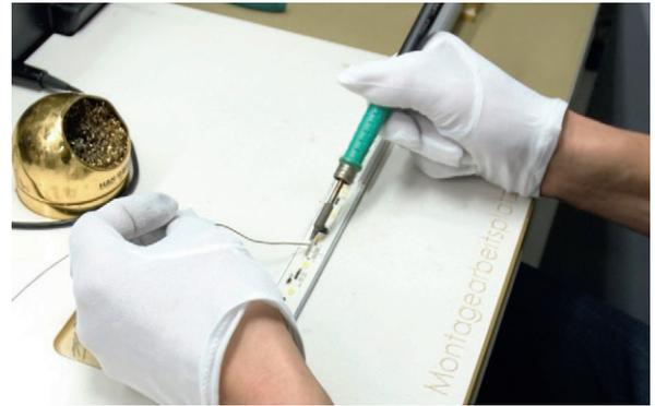
Bild 15. Manueller Lötprozess von LED-Leuchstreifen
