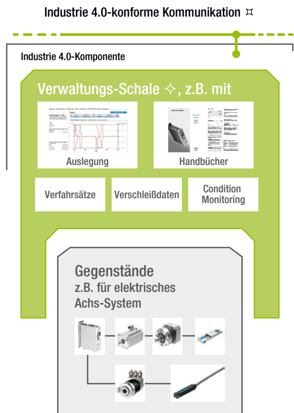
Abbildung 27: Industrie 4.0-Komponente bestehend aus mehreren Gegenständen
