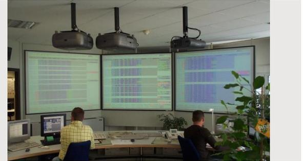
ProVis.Agent überwacht im Werk Bremen rd. 450 speicherprogrammierbare Steuerungen von rd. 3.000 Anlagen vom Rohbau über Lackierung bis zur Montage.
