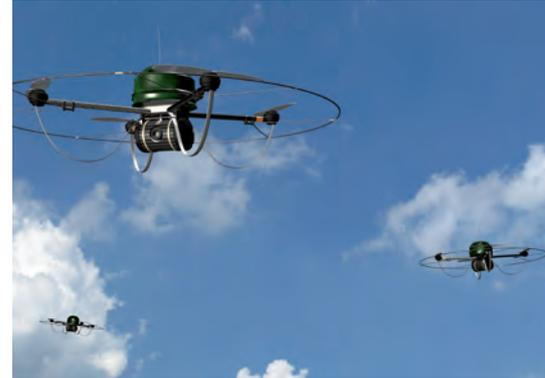
Vernetzte Aufklärung und Überwachung mit mobilen und ortsfesten Sensoren. Komplexe Aufklärungs- und Überwachungsaufgaben lassen sich oft nicht mit stationären Sensoren lösen. IOSB Quadcopter-Verbund zur Aufklärung und Überwachung.
