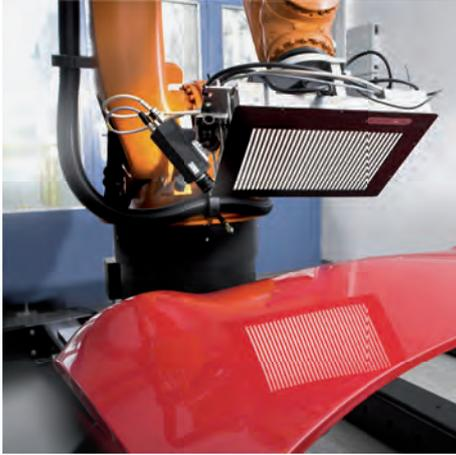
Mittels Deflektometrie werden Fehler und Beschädigungen in spiegelnden Oberflächen sichtbar.
