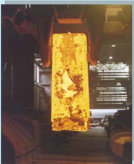
Diffusionsgeglühte (1.250°C) Stahlbramme, rd. 150 t, Prozeßregelung und Leitsystem vom IITB
